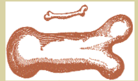
Dibujo de Galileo que muestra un hueso y otro tres veces más largo y proporcionado para que realice la misma función que el pequeño.
