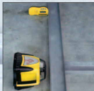
Rugby 200 mit Rod-Eye Sensor im Vertikalbetrieb
